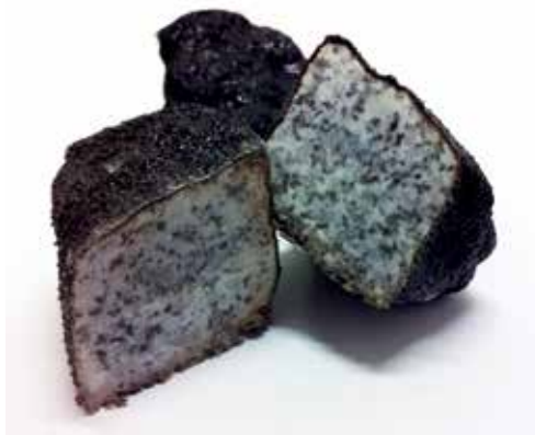
NEOBALLAST reduce la degradación del balasto y atenúa el ruido y las vibraciones derivadas de la circulación de trenes.
