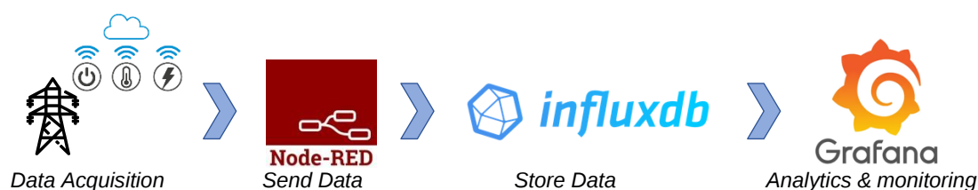
Figura 3. Arquitectura de software del prototipo instalado en la cruz superior de la torre.
